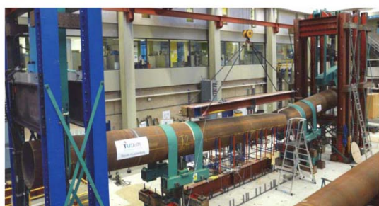
Σχήμα 2. Αρχικώς η μέθοδος προσομοίωσης με πεπερασμένα στοιχεία επαληθεύεται έναντι πειραμάτων μονοαξονικής μετατόπισης του αγωγού μέσα στο έδαφος αλλά και έναντι πειραμάτων καμπτικής καταπόνησης του αγωγού.
