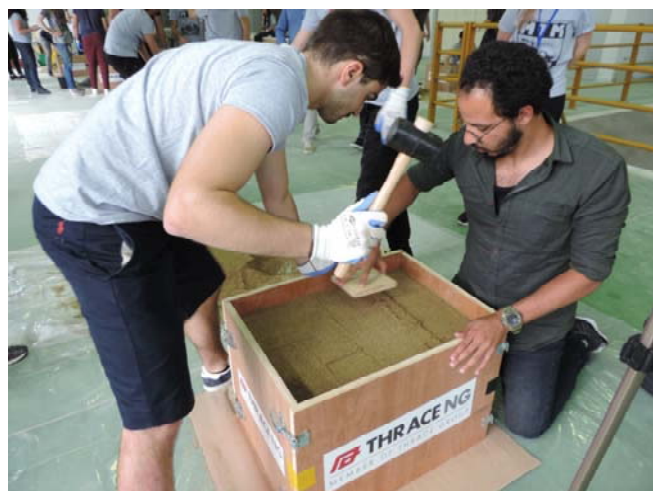
Εικόνα 2. Διάστρωση και συμπύκνωση οπλισμένου εδάφους από τους φοιτητές.
