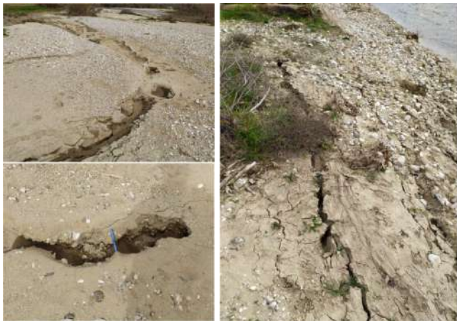
Εικόνα ΓΕΩ11. Χαρακτηριστικές αποτυπώσεις φαινομένου ρευστοποίησης και επαγόμενης πλευρικής εξάπλωσης στην ευρεία κοιτή του Τηταρήσιου ποταμού (Θέση L2) (Συν/νες θέσης φωτογραφίας: N39°43'31.74"; E22°8'20.28" (αριστερά πάνω), N39°43'31.43"; E22°8'19.16" (αριστερά κάτω) N39°43'32.83"; E22°8'16.60" (δεξιά))
