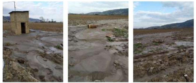
Εικόνα ΓΕΩ15. Αποτύπωση εκτεταμένης ρευστοποίησης σε θέσεις νοτίως της Πηνειάδας πλησίον του ποταμού Πηνειού (Θέση L4) (Συν/νες θέσης φωτογραφίας: N39°34'56.05"; E22°10'8.24" (αριστερά), N39°34'56.18"; E22°10'8.16" (μέση), N39°34'56.04"; E22°10'8.25" (δεξιά))
