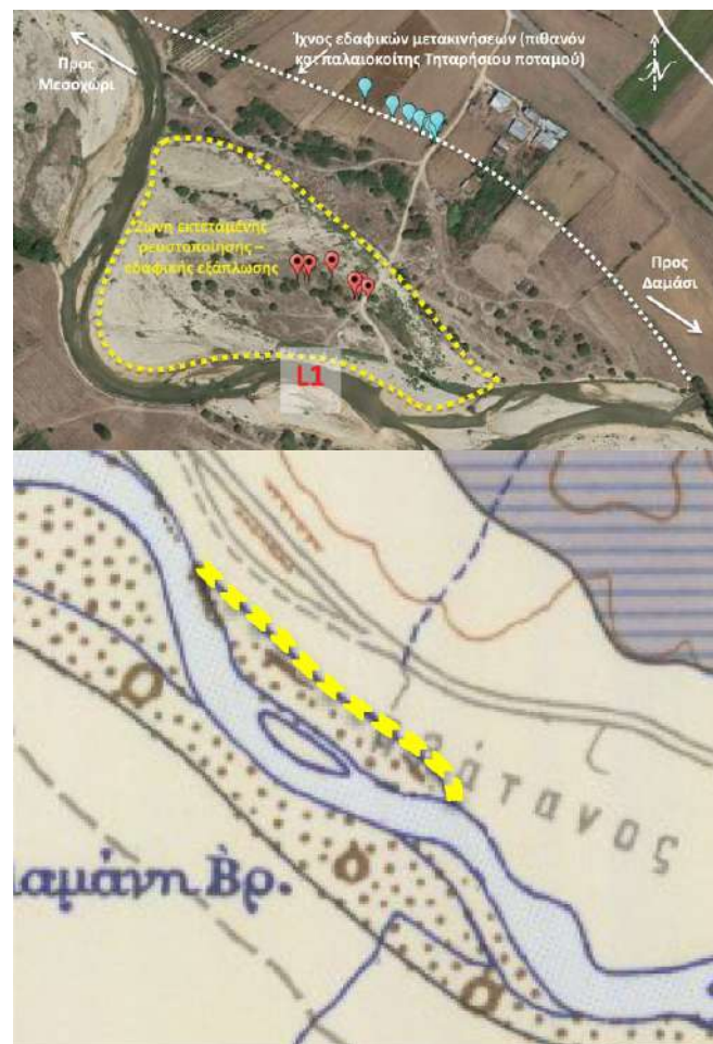
Εικόνα ΓΕΩ12. Άνω: Αποτύπωση εδαφικής ρωγμής (άσπρη διακεκομμένη γραμμή) μεγάλου μήκους η οποία φαίνεται να ακολουθεί το όριο μεταξύ των φερτών αλλουβιακών υλικών της ευρείας κοίτης και των υλικών αποσάθρωσης του ανάντη ευρισκόμενου ορεινού όγκου. Κάτω: Εντοπισμός θέσης της εδαφικής ρωγμής στο σχετικό απόσπασμα του γεωλογικού χάρτη ΙΓΜΕ.
