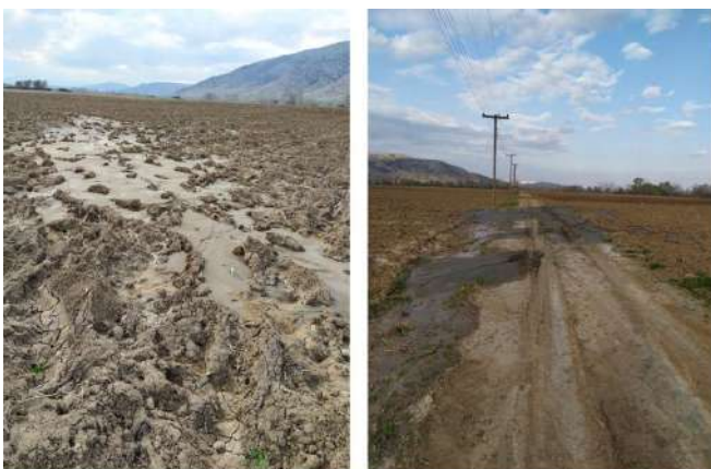
Εικόνα ΓΕΩ14. Αποτύπωση εκτεταμένης ρευστοποίησης σε θέσεις νοτίως της Πηνειάδας πλησίον του ποταμού Πηνειού (Θέση L3) (Συν/νες θέσης φωτογραφίας: N39°34'53.21"; E22°10'39.77" (αριστερά), N39°34'54.57"; E22°10'41.94" (δεξιά))
