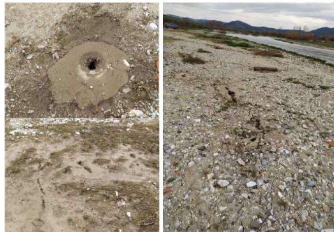
Εικόνα ΓΕΩ10. Χαρακτηριστικές αποτυπώσεις φαινομένου ρευστοποίησης και επαγόμενης πλευρικής εξάπλωσης στην ευρεία κοίτη του Τηταρήσιου ποταμού (Θέση L1) (Συν/νες θέσης φωτογραφίας: N39°44'5.50"; E22°6'52.89" (αριστερά πάνω), N39°44'4.88"; E22°6'53.81" (αριστερά κάτω) N39°44'5.45"; E22°6'51.51" (δεξιά))
