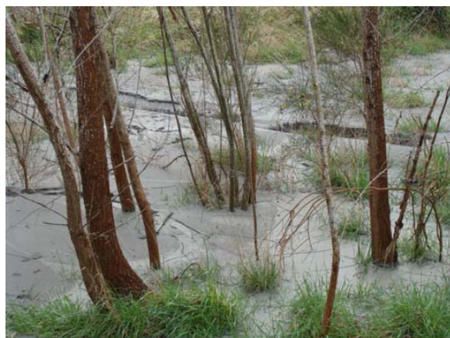
Εικόνα 15. Εκτεταμένα φαινόμενα ρευστοποίησης κοντά στον ποταμό Waimakariri
