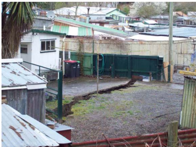
Εικόνα 16. Εδαφική ρωγμή από πλευρική εξάπλωση λόγω ρευστοποίησης κοντά στον ποταμό Waimakariri
