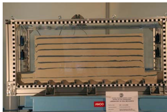
Φωτ. 4α, β. Το εργαστηριακό προσομοίωμα ολοκληρωμένο και τοποθετημένο επί της σεισμικής τράπεζας ακριβώς πριν από το πείραμα
