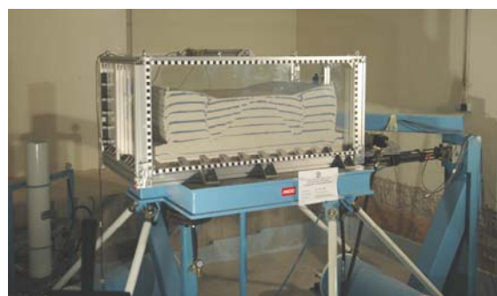
Φωτ. 4α, β. Το εργαστηριακό προσομοίωμα ολοκληρωμένο και τοποθετημένο επί της σεισμικής τράπεζας ακριβώς πριν από το πείραμα
