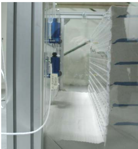
Φωτ. 3. Το εργαστηριακό προσομοίωμα ολοκληρωμένο. Διακρίνονται τα δύο μετακινήσιμπτρα.
