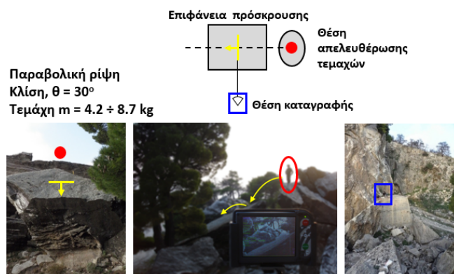
Σχήμα 8. Διάταξη επιτόπου δοκιμών στη Σηλιά Νταβέλη στην Πεντέλη
